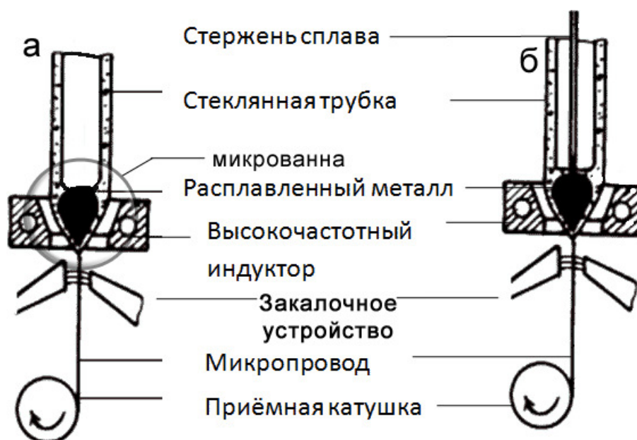
Рис.1.9. Получение металлического микропровода в стеклянной оболочке по методу проф. А. Улитовского: капельный способ (а), непрерывный способ (б)
