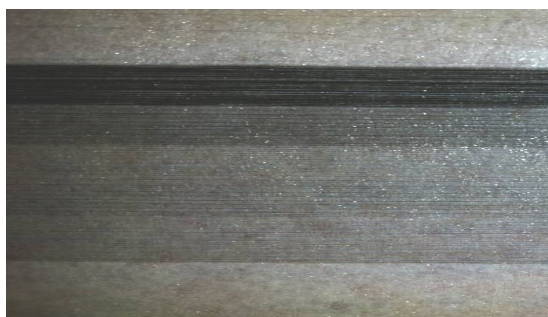
Рис. 2.4. Пример градиентной раскладки микропровода на барабане
